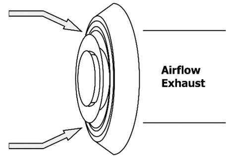
Le système de retour d'air vicié est utilisé pour aspirer l'air des points du bâtiment où surviennent les pires problèmes de qualité de l'air. Il est recommandé d'utiliser des registres d'équilibrage ou des grilles réglables sur toutes les canalisations de retour d'air utilisées pendant l'installation pour équilibrer la circulation d'air dans les différentes zones du bâtiment.
