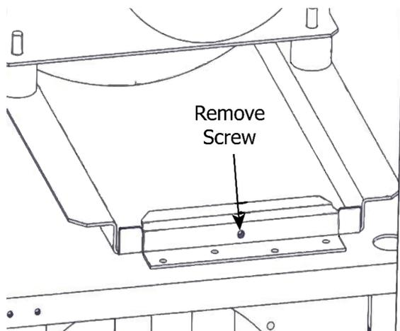
7. Retirez la vis de continuité de mise à la terre qui maintient les bacs de soufflante supérieur et inférieur fixés aux butées.
