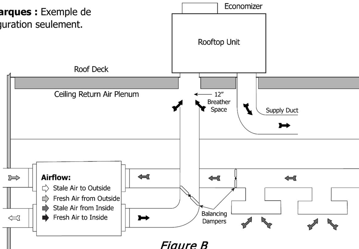
De nombreux bâtiments sont dotés d'un plénum de retour au plafond comme dans la figure B. De l'air frais provenant du VRC peut être introduit directement dans le plafond, mais cela devrait se produire près de l'admission de l'appareil de traitement d'air.
