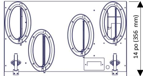
**Remarque :** nous recommandons un dégagement avant de 25 po (635 mm) pour faciliter l'entretien de l'appareil. Les orifices sont à collet ovale de 5 po (125 mm) ; un registre d'équilibrage se trouve dans chacun des collets.
