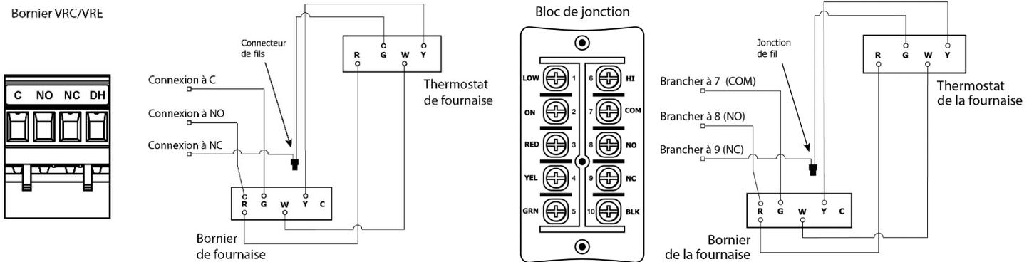
Connexions du système de traitement d'air/ventilateur de fournaise avec bornier de type B
