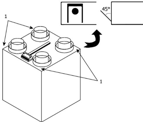
1. Repérer les quatre pattes de fixation sur les côtés gauche et droit de l'unité, à l'avant et à l'arrière.
