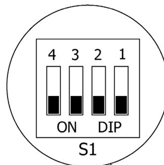
**Remarques :** La basse vitesse n'est pas réglable; le réglage d'usine de l'interrupteur 1 est activé.
