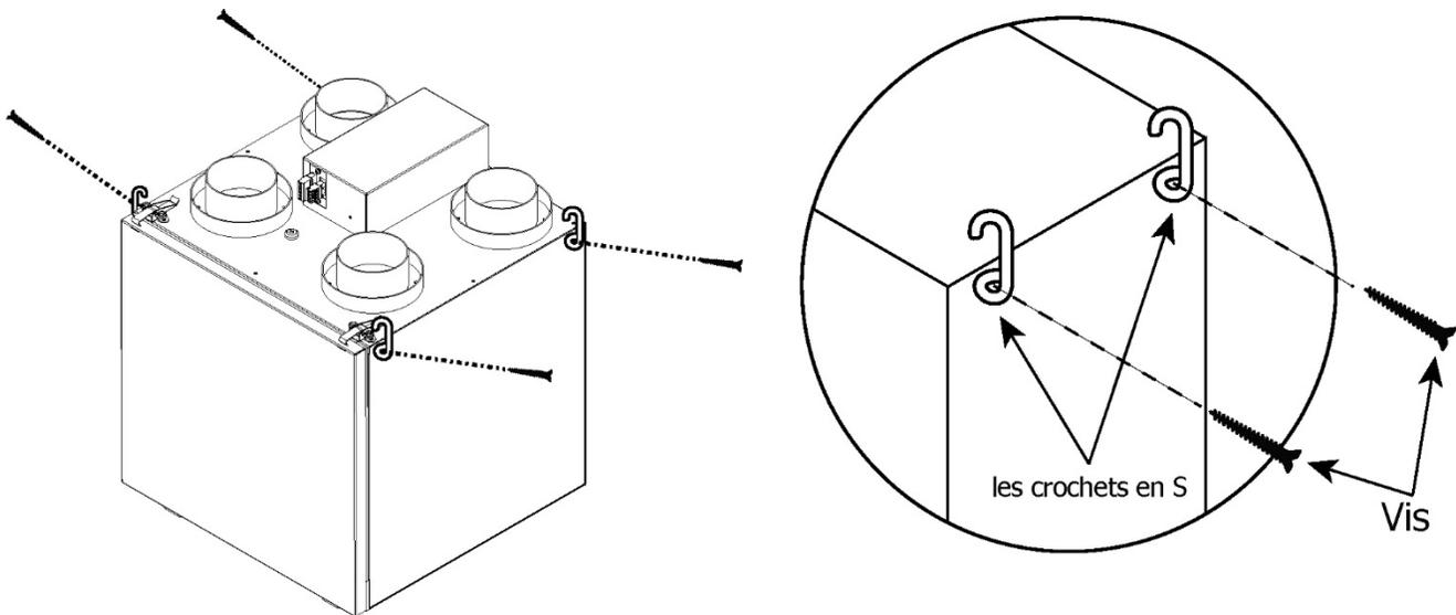
1. Les emplacements de montage sur le RNC 88 utilisent du matériel de montage standard, identique à celui des autres VRC RNC.
